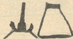
Aufhängen Vorrichtung zum Aufhängen des Kessels und Steigbügel
